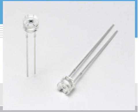
視感度に近い分光感度特性をもったフォトICダイオードです。チップ上には2つの受光部があり、電流アンプ回路中で2つの受光部の出力を減算し、ほぼ可視光域にのみ感度をもたせています。また、従来品に比べ、同一照度における色温度誤差を低減しています。S9648-100は、メタルパッケージと同じ形状のプラスチックパッケージを採用しています。当社製可視光導電素子の5SRタイプに形状が類似しており、可視光導電素子の置き換えが容易です。
